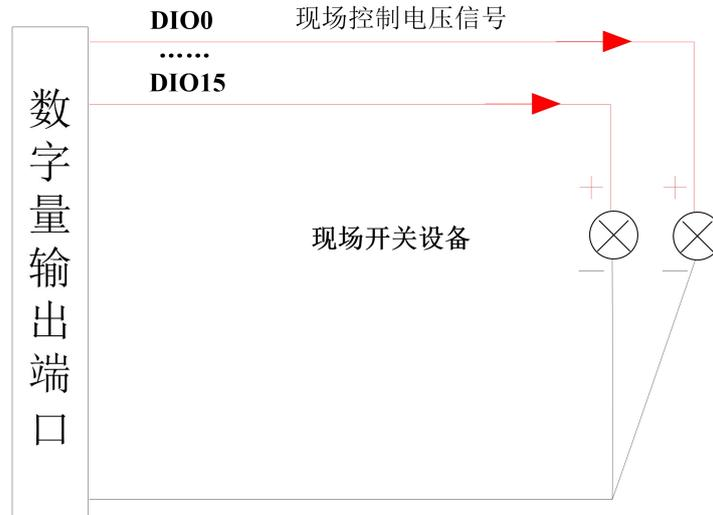
图 3-6 开关量输出接线示意图
