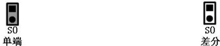
图 2-5 AD 接线方式跳线
