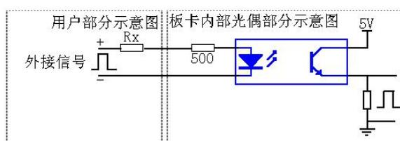
其中 Rx 是一个限流电阻其选择按照这样的原则: Rx 和板卡内部的 500 欧姆限流电阻可以将流过发光二极管的电流限制在 10mA 左右。
